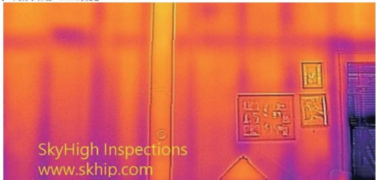
使用熱顯像儀顯示木樁和黑影的位置,木樁中間位置是隔熱層
